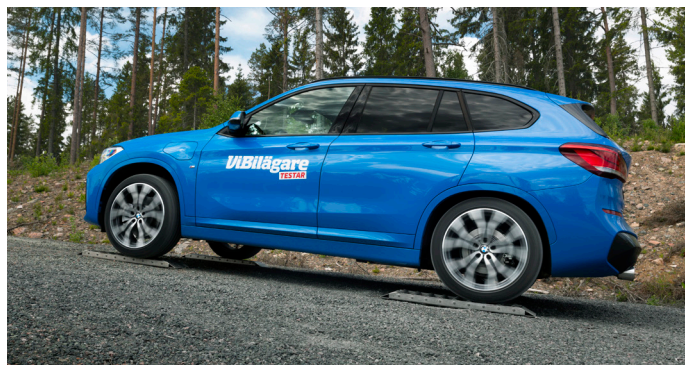
BMW och Peugeot har elektrisk fyrhjulsdraft via elmotor på bakaxeln. Det fungerar väl i BMW medan Peugeot lider av stor kraftfördröjning.
